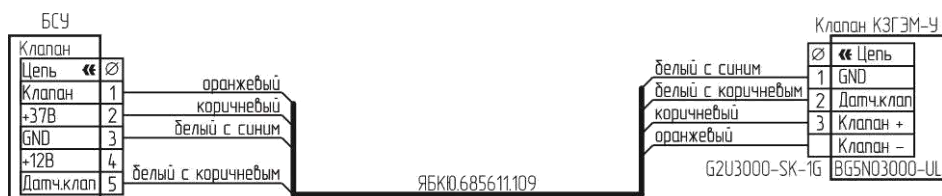
Рисунок Б.4 – Схема подключения клапана КЗГЭМ-У с разъемом BG5N03000-UL.
