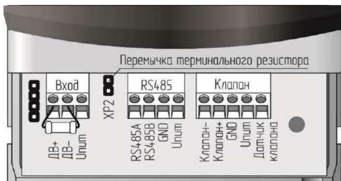
Рисунок В.2 – Расположение разъемов сигнализатора С3-1Е-485(Р).
