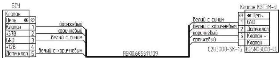
Рисунок А.7 – Схема подключения клапана КЗГЭМ-У с разъемом BG5NO3000-UL.
