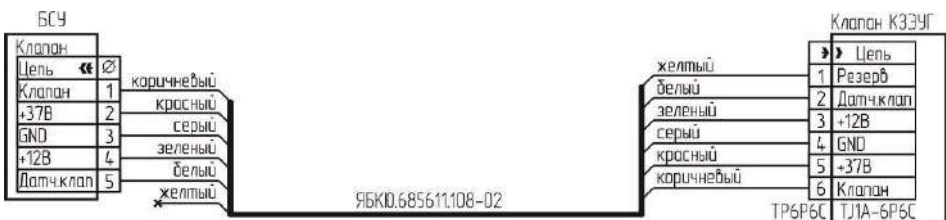
Рисунок А.9 – Схема подключения клапана КЗЭУГ с разъемом TJ1A-6P6C.
