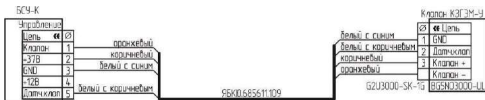
Рисунок В.4 – Схема подключения клапана КЗГЭМ-У с разъемом BG5NO3000-UL. Установить S3.7(тип клапана) OFF - «КЗГЭМ-У, КЗЭУГ»
