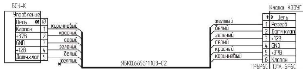
Рисунок В.6 – Схема подключения клапана КЗЭУГ с разъемом TJ1A-6P6C.
