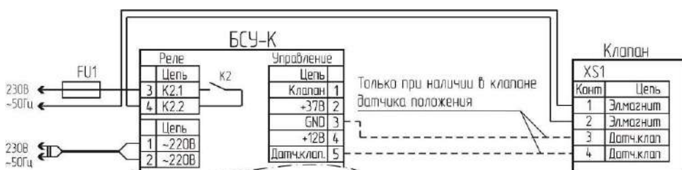
Рисунок В.10 – Схема управления вентиляцией.
