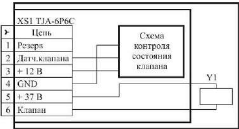
Рисунок 2 – Схема электрическая принципиальная клапана
