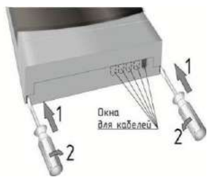
Рисунок 2 – Снятие крышки клеммного отсека
