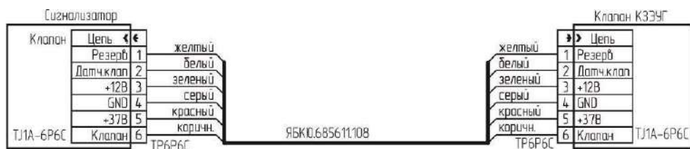
Рисунок В.2 – Маркировка кабеля с разъемом ТР6Р6С для клапана КЗЭУГ.
