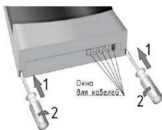
Рисунок 2 – Снятие крышки клеммного отсека
