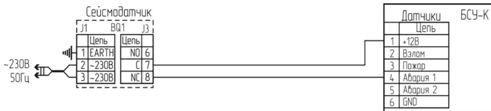
Рисунок Г.5 – Типовая схема подключения сейсmodатчика
