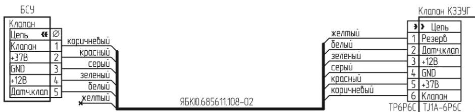
Рисунок Г.7 – Схема подключения клапана КЗЭУГ с разъемом TJ1A-6P6C.
