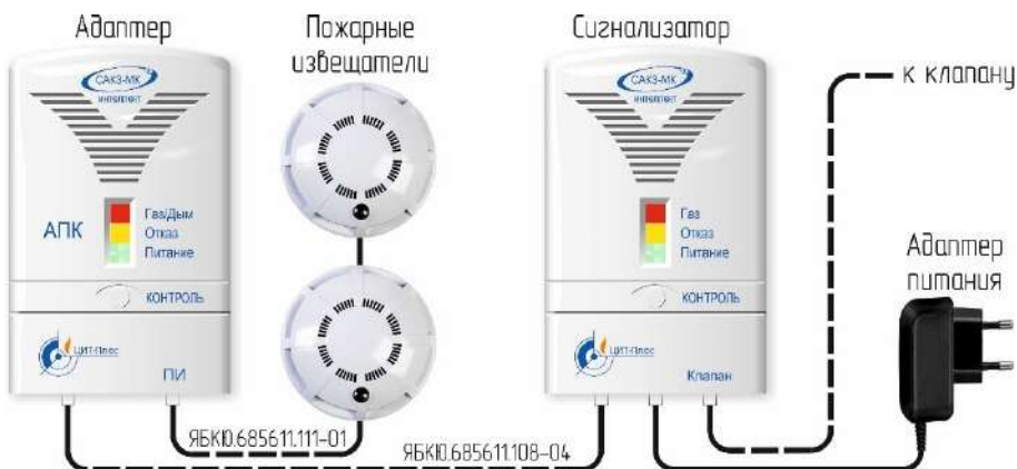
Рисунок В.2 – Типовая монтажная схема подключения пожарных извещателей
