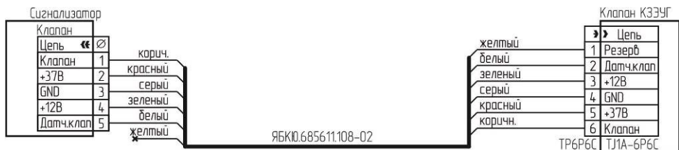
Рисунок В.4 – Схема подключения клапана КЗЗУГ с разъемом TJ1A-6P6C
