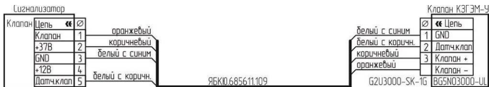
Рисунок В.3 – Схема подключения клапана КЗГЭМ-У с разъемом BG5NO3000-UL.
