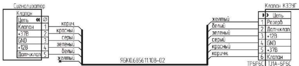
Рисунок В.4 – Схема подключения клапана К3ЗУГ с разъемом TJ1A-6P6C
