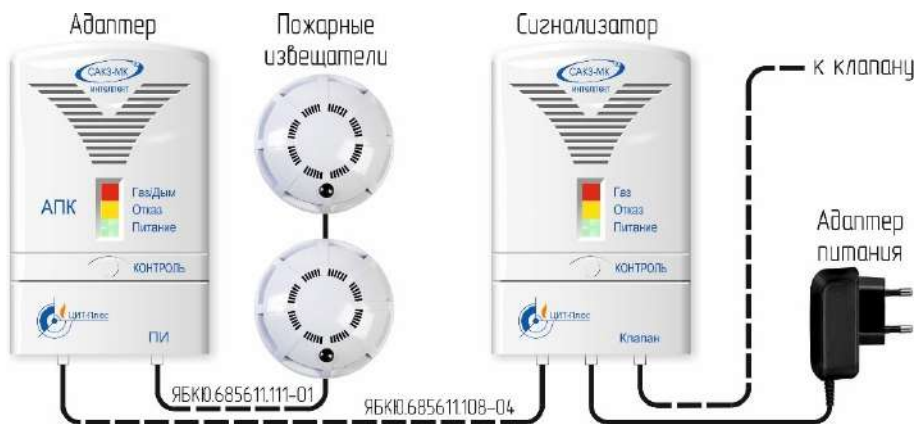
Рисунок В.2 – Типовая схема с клапаном и пожарными извещателями
